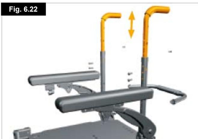
7. Vuelva a colocar los tornillos en los tubos del respaldo. Utilice una torsión de ajuste de 10 Nm (Fig. 6.23).
