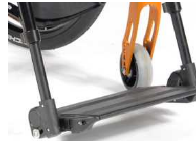
Plataforma única aluminio, ajustable en ángulo y profundidad
