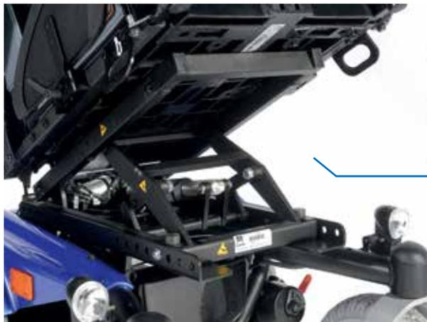
Módulo de basculación eléctrica (de 0° a 30°) que además permite ajuste del centro de gravedad para conseguir un balance correcto de pesos.
