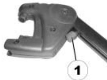
El tope de goma puede enroscarse o desenroscarse (A) o desplazarse hacia arriba o hacia abajo (B).
